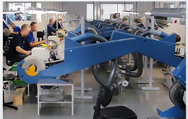
Sondermaschine für Schleifen am freien Band und Drehrichtungsumkehr Special version for slack belt grinding and reverse turning direction
